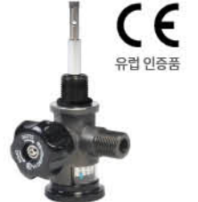
용기밸브 (과류 방지밸브 기능) 용기밸브 파손 등으로 급속한 공기 유출을 방지하여 용기가 자체 비상하는 위험성을 방지
